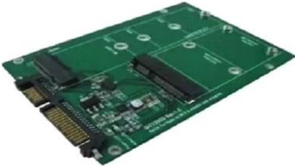
图 2-1: M.2 (NGFF) SSD & MSATA SSD 转 SATA3 转接卡支持 SSD 类型 (见图 2-2) :
